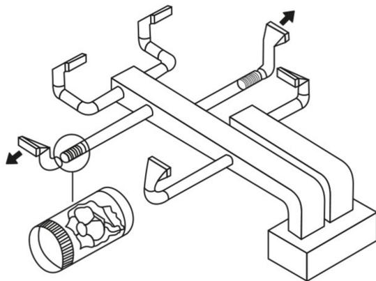
Extracción ó inyección por conducto individual.
